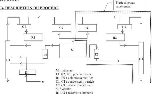
On obtient du pentanol pur en pied de la colonne **D1** et de l'eau pure en pied de la colonne **D2**.
